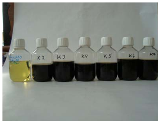
Mobil Arctic 300 Oljorna är alla mycket mörka och behöver skiftas ut över lag. Sköljning 200 tim innan skarpt byte ! Överväga alternativ produkt längre fram ! Ljusa oljan är oanvänd produkt.
