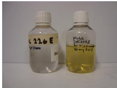
SHC226E som stått en-två veckor blir så här gul i den del som ligger i slang, övrig volym påverkas inte !
